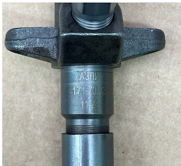
Рисунок 1 – Маркировка форсунок 171.1112010 и их модификаций.
