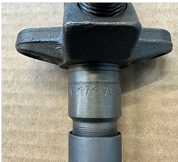
Рисунок 1 – Маркировка форсунок 171.1112010 и их модификаций.
